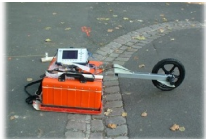
Appareillage de méthode radar basse fréquence
